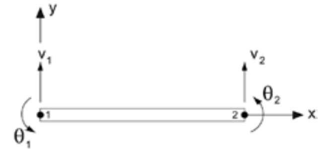
Hình 1. Phần tử dầm Hermitian
