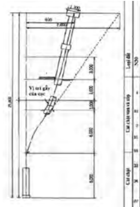
Hình 2. Hình ảnh cọc bị phá hủy của cầu Showa[4]
