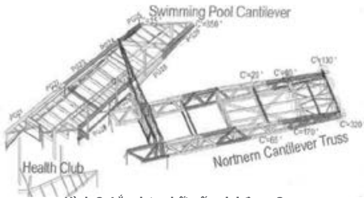
Hình 8. Lắp dựng kết cấu giai đoạn 2
