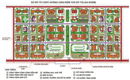
Hình: 3.11: Sơ đồ Tổ chức không gian điểm TOD đô thị, với ga ĐSDT ngầm
