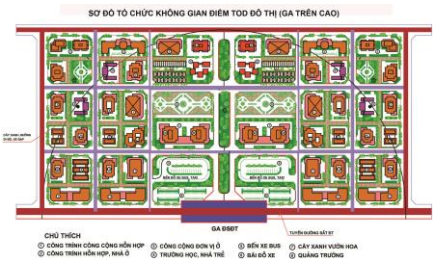
Hình: 3.13: Sơ đồ Tổ chức không gian điểm TOD đô thị, với ga ĐSDT trên cao
