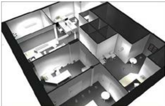
Hình 1. Kết quả mô phỏng chiếu sáng tự nhiên nội thất phần mềm Dialux 4.3 [6]
