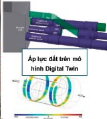
Hình 5: Áp dụng Digital Twin cho đoạn hầm CP4a và CP3a, dự án Crosswell, London, Anh
