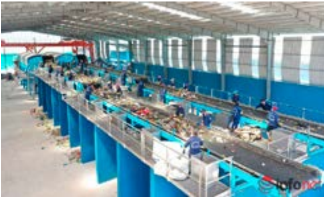
Hình 3. Dây chuyền phân loại rác thải chế biến phân hữu cơ tại BIWASE
