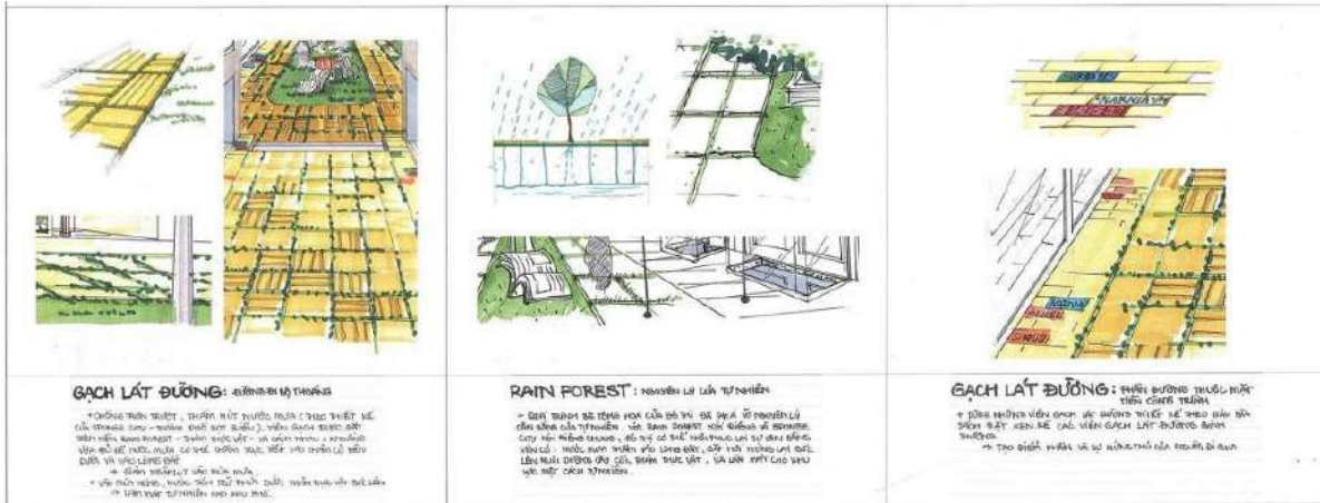
Hình 3.19: Minh họa vật liệu gạch trồng cỏ giúp thoát nước bề mặt
