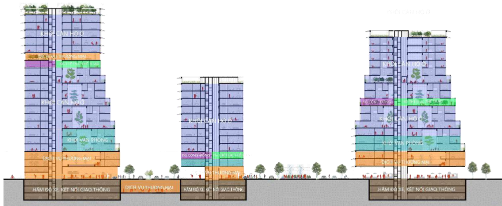
Hình 3.17: Sơ đồ giải pháp tích hợp các KG DVTM và KGCCC trên các tầng
