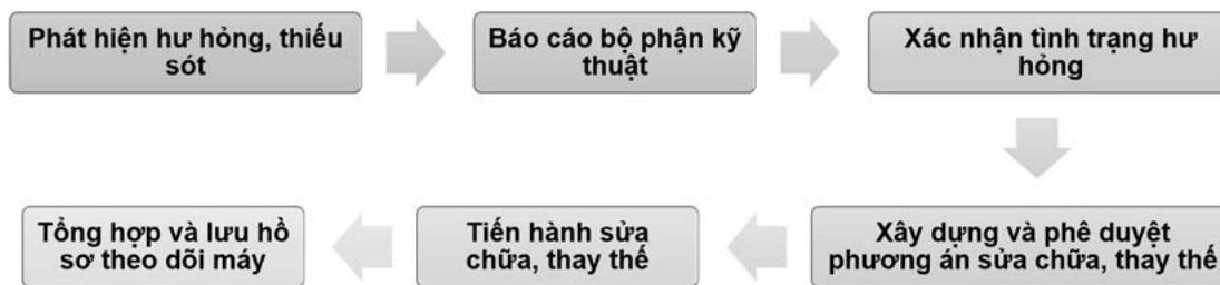
Hình 4 – Đề xuất quy trình sửa chữa, thay thế máy xây dựng bị hư hỏng
