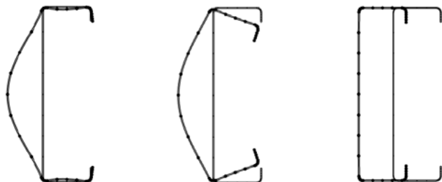
a) Mất ổn định cục bộ b) Mất ổn định méo c) Mất ổn định tổng thể
