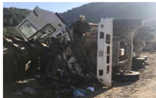
Hình 1 – Xe tải bị lật do mất phanh khi đang làm việc Nguồn: internet, tháng 10/2019
