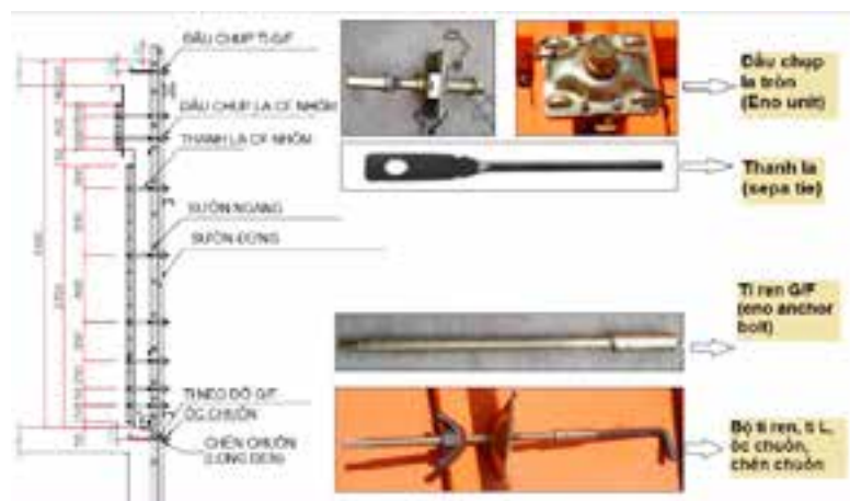
Hình 5. Cố định tấm Gang form, các phụ kiện Gang form
