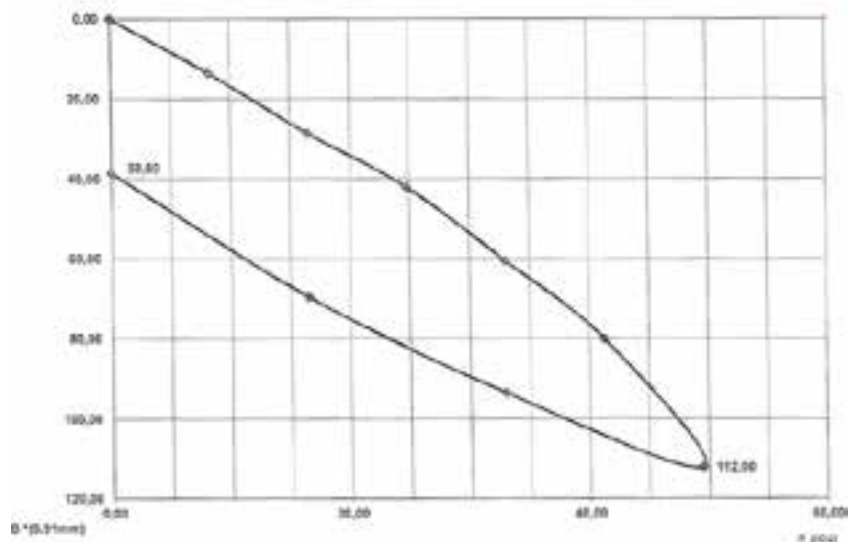
Hình 2.10 Kết quả thí nghiệm nén ngang cọc 11HA193 [8]
