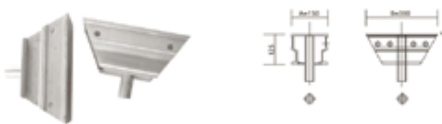
Hình 2.6. Hình Cột chống
