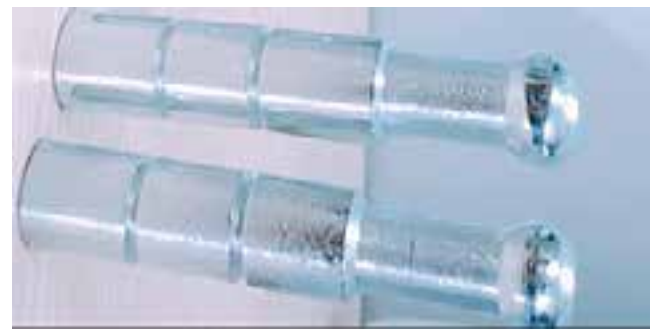
Hình 5. Hình ảnh mốc quan trắc lún
