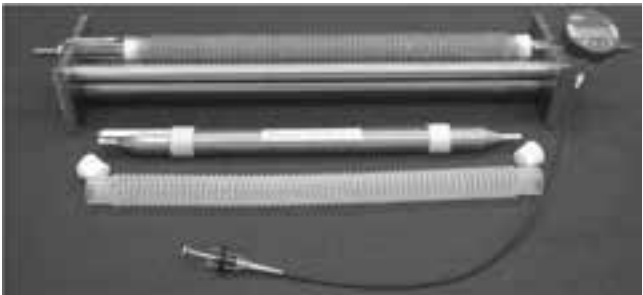
Hình 4. Thiết bị thí nghiệm đo độ co tự sinh theo ASTM C1698
