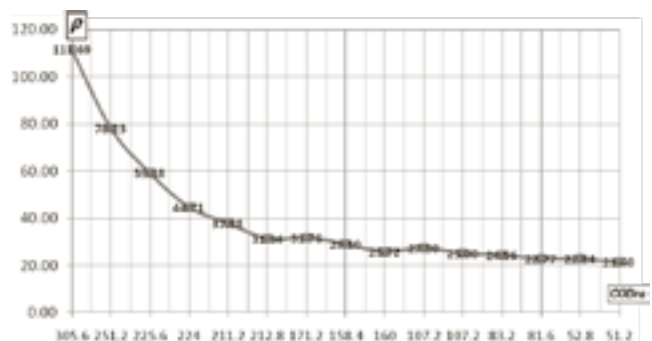
Hình 8. Quan hệ giữa tốc độ xử lý riêng ( \rho ) của sinh khối bùn hoạt tính với nồng độ chất hữu cơ đầu ra COD ra
