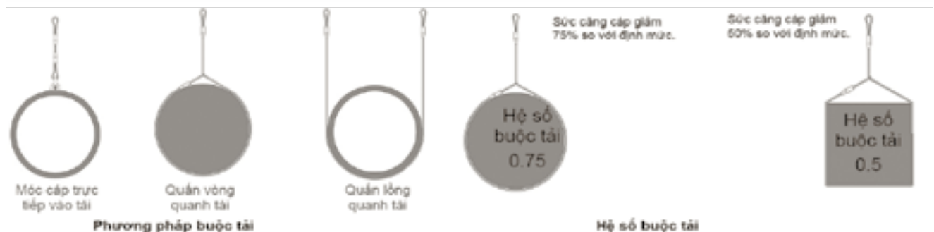
Hình 14. Phương pháp và hệ số buộc tải
