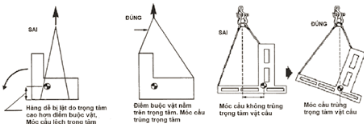
Hình 13. Chỉ dẫn vị trí móc cầu hợp lý
