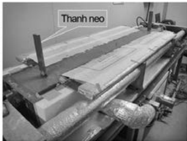
a) Thanh neo được chôn vào vị trí cross-head
