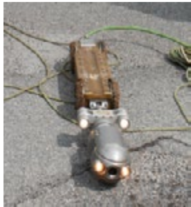
Hình 1: Camera gắn trên robot
