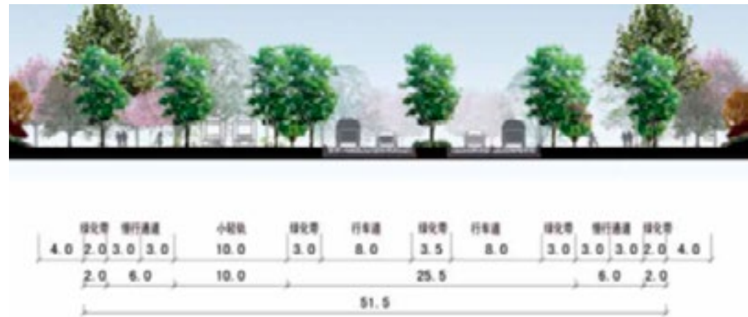
Hình 8: Mặt cắt ngang đường 4 làn xe ở Thiên Tân, [13]
