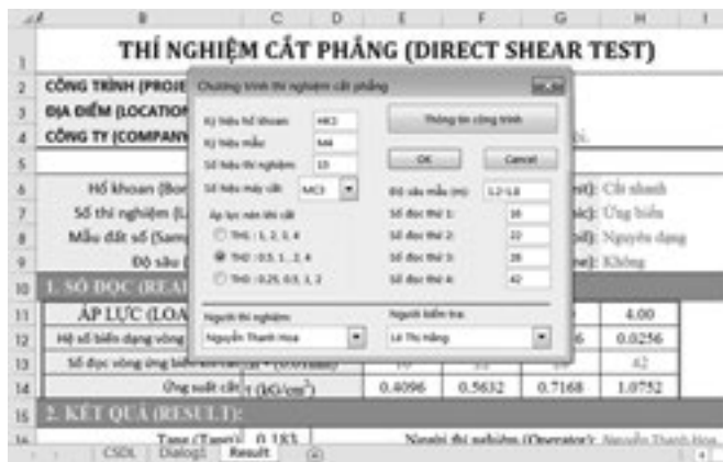
Hình 10. Giao diện chương trình thí nghiệm cắt phẳng đất trong phòng
