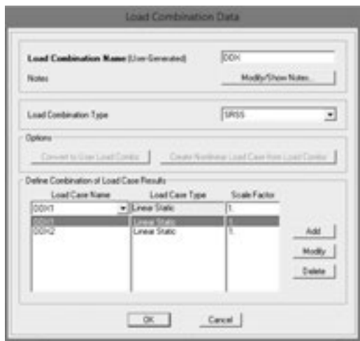
Hình 3. Định nghĩa trong SAP2000 cho tổ hợp SRSS hai dạng dao động do động đất
