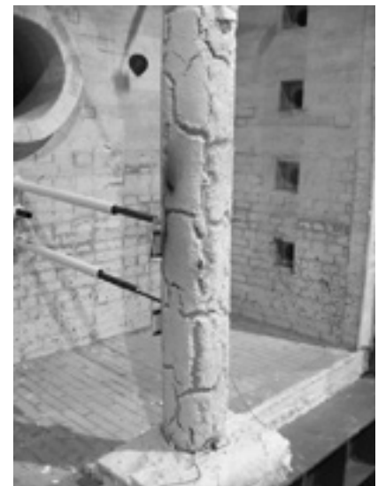
Hình 3. Cột thép sơn chống cháy sau khi chịu nhiệt độ cao [8]
