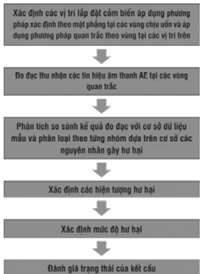
Hình 7. Quy trình triển khai đo đạc và quan trắc bằng phương pháp sóng âm thanh
