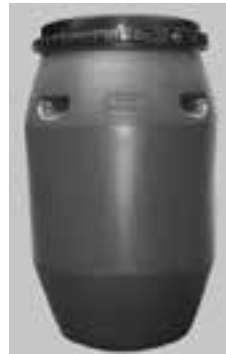
Hình 6. Thùng phân tích khối lượng riêng dung tích 50 lít, màu xanh dương, có nắp đậy; đường kính ngoài miệng: 330 mm; đường kính ngoài thân: 380 mm; Chiều cao thùng ko nắp: 580 mm, Trọng lượng: 3kg
