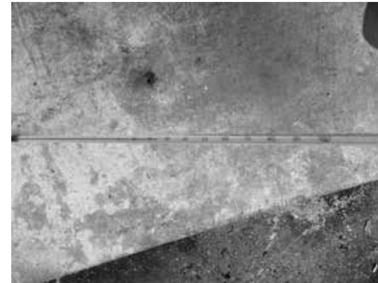
Hình 8. Nhiệt kế que dài thủy ngân đo nhiệt độ CTR
