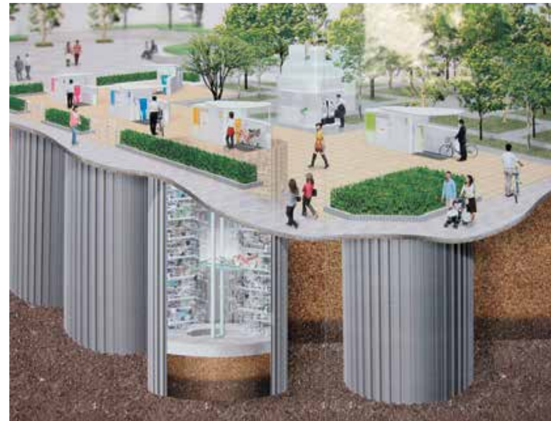
Hình 1: Hệ thống đỗ xe ngầm tự động ở Nhật Bản
