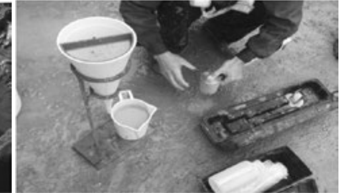
Hình 3. Bentonite bị nhiễm bê tông, kiểm tra và thay Bentonite
