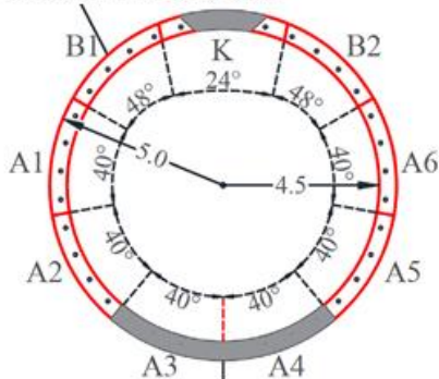
Hình 3. Vị trí các tấm lắp ghép trong mặt cắt ngang hầm
