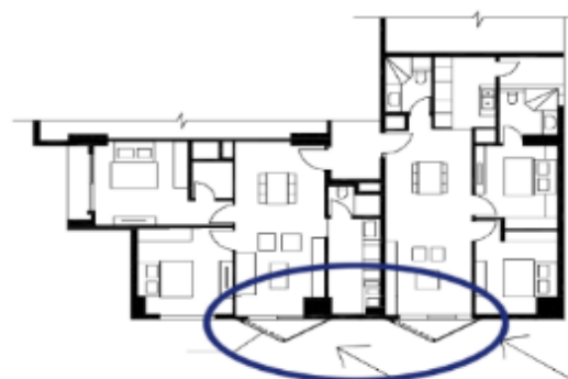
Hình 12. Mặt bằng 2 căn hộ điển hình áp dụng giải pháp Hiên tam giác và lam chắn nắng.
