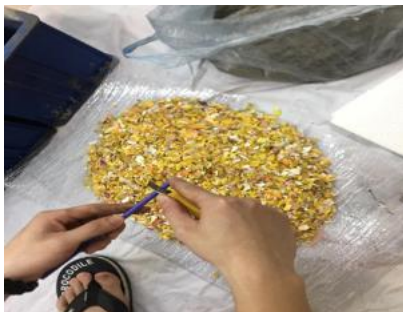
Hình 3. Mẫu nhựa sau khi ép cán mỏng và được cắt nhỏ
