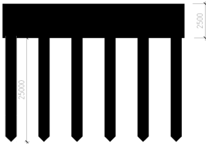
Hình 2. Mô hình bố trí hệ bè cọc trong trường hợp 1
