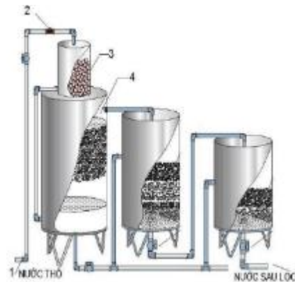
Hình 8. Hệ thống lọc nguồn nước nhiễm kim loại.
