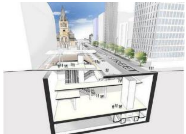
Hình 1. Bố trí điển hình ga tàu điện ngầm thi công bằng phương pháp đào lộ thiên
