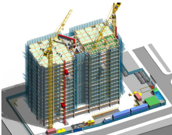
Hình 4. Mô hình toàn cảnh thi công được mô hình hóa bằng phần mềm Autodesk Revit
