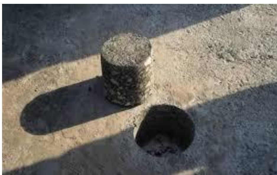
Kiểm tra và thí nghiệm bê tông tại hiện trường
