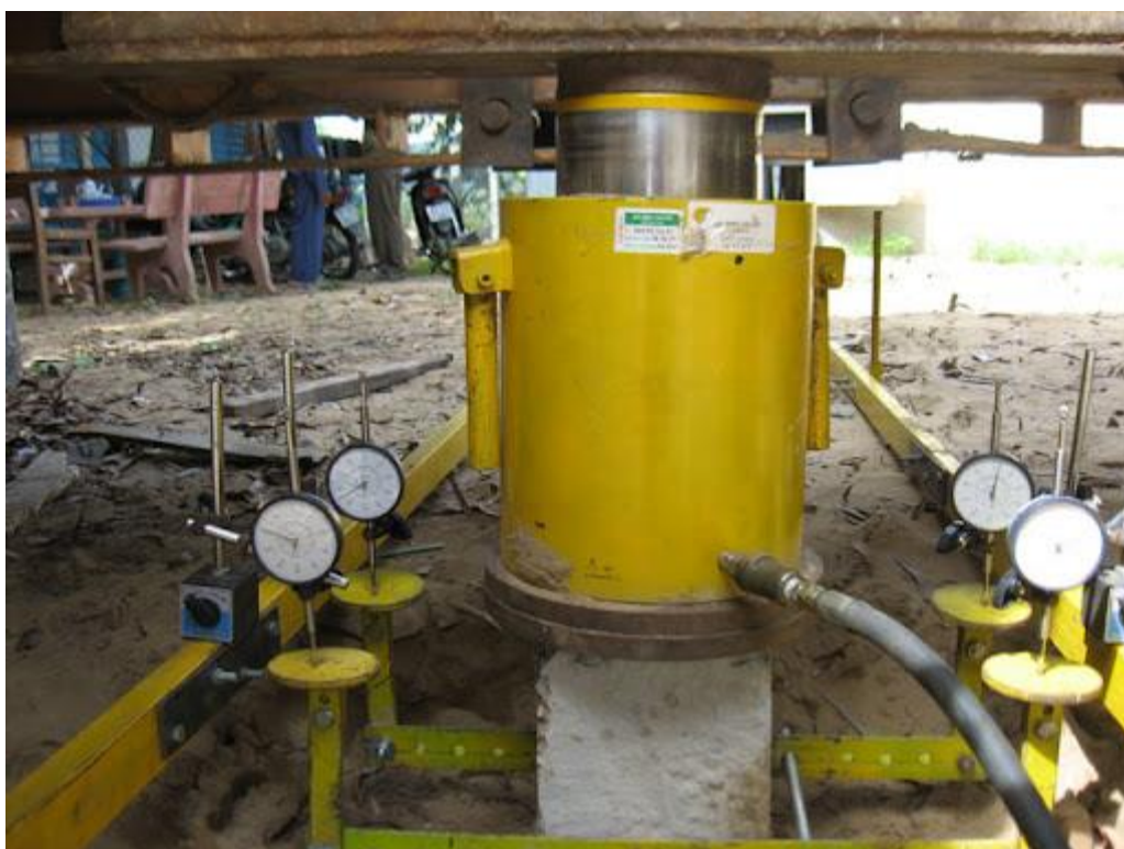
Thí nghiệm nén tĩnh cọc BTCT
