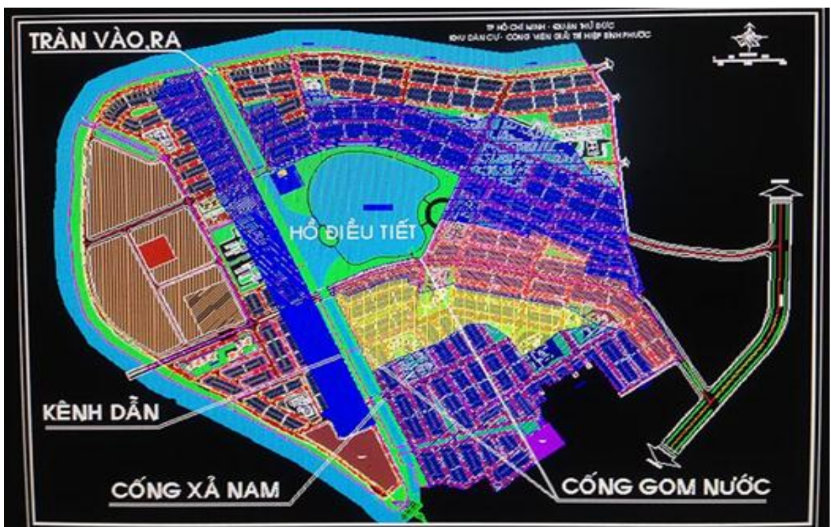
Hình 1.6. Công trình hồ điều tiết chống ngập của Dự án dân cư - vui chơi giải trí Hiệp Bình Phước [63]
