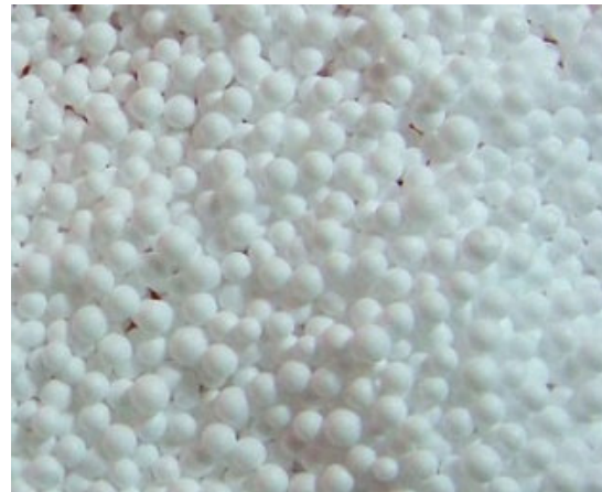
Hình 1.13. Vật liệu nổi polystyrene [15]
