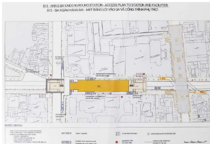
Hình 3.49: Mặt bằng vị trí, các lối vào ga ngầm (Nguồn: Dự án tuyến đường sắt đô thị số 3)
