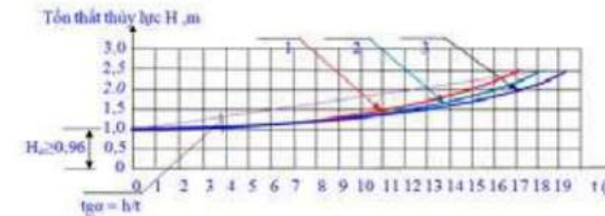
Hình 6. Đồ thị quan hệ phụ thuộc tổn thất lọc H – thời gian lọc t
