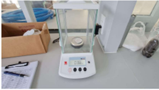
Hình 1: Đo cặn lơ lửng trong phòng thí nghiệm
