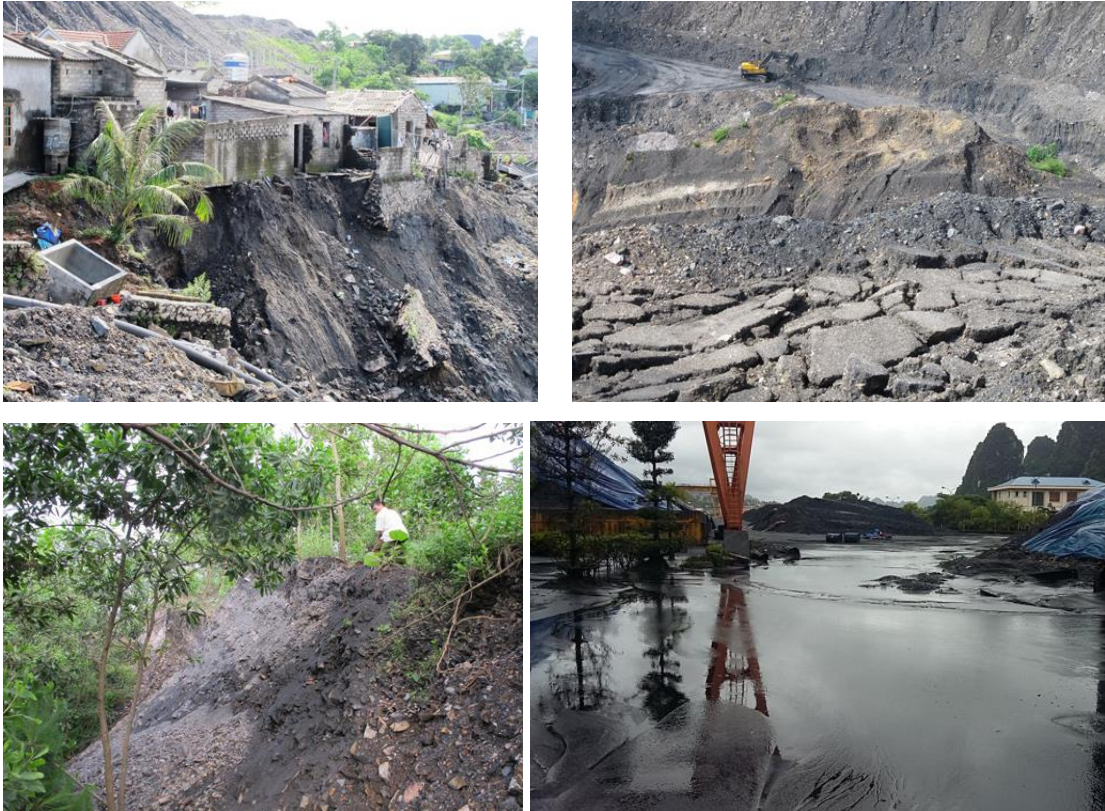
Hình PL4.8. Một số hình ảnh về vùng sụt lở xung quanh khai trường và mưa lớn gây ngập mong via 16, mỏ than Núi Béo
