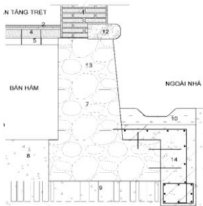
Hình 3. 8 Gia cố cấu kiện Móng
